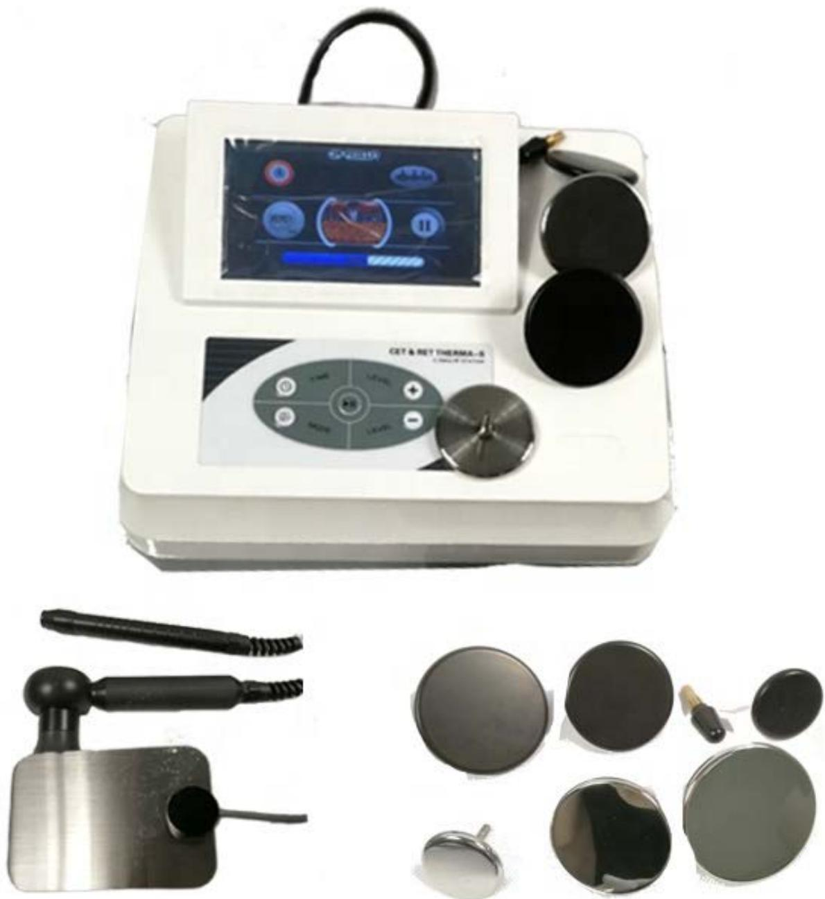
Questa tecnologia lavora sia in modalità capacitiva (CET trasferimento elettrico capacitivo), attraverso un elettrodo isolato, sia in modalità resistiva (RET trasferimento elettrico resistivo) attraverso un elettrodo non isolato che consente di ottenere un aumento della temperatura ad una maggiore profondità.
